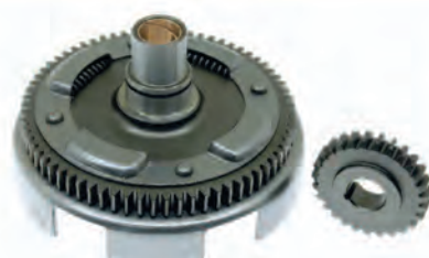
ART. 5984 z 27 x 69 dentatura DIRITTA (con parastrappi) STRAIGHT cogs (with cush gear) VESPA 125 PRIMAVERA - ET3 - PK 125 ...
